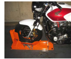
震度7の地震でもバイクが転倒しないよう安全性が確認された専用機器を設置しています。
